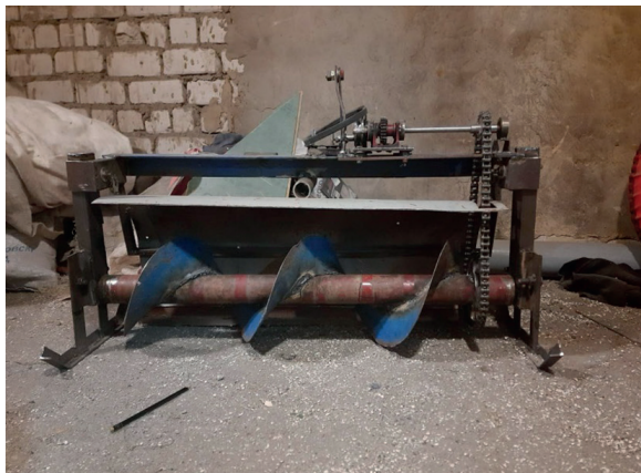
Рис. 2. Шнекоснеготбрасывающее однокомпонентное активное навесное оборудование
