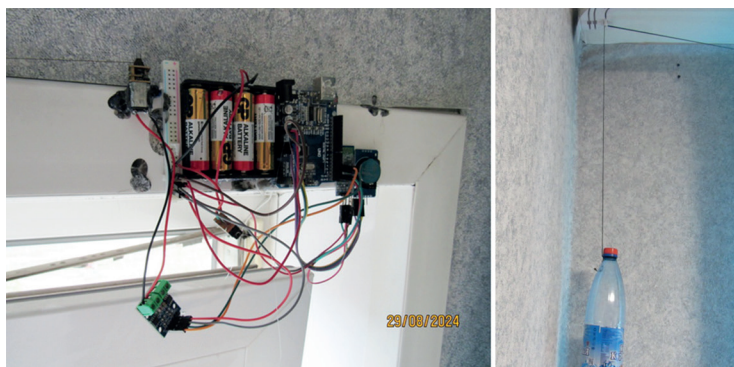
Рис. 4. Собранное устройство на оконной раме и противовес
