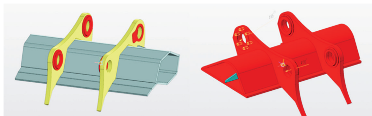
Измененная и оригинальная конструкция силовой балки ковша
